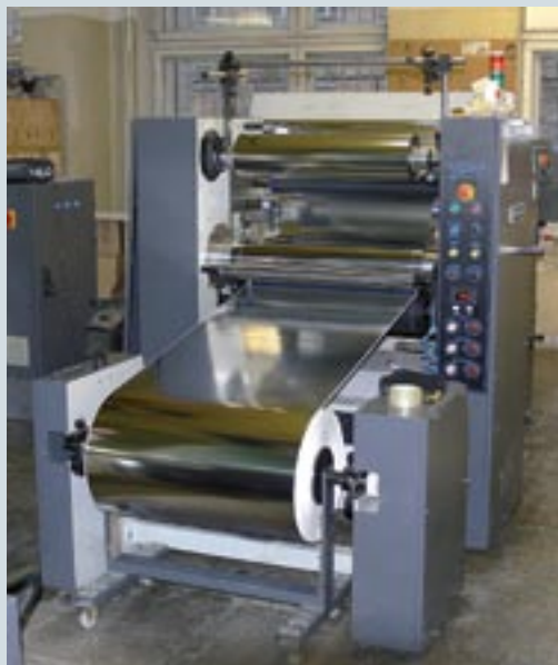
Ламинатор для изготовления металлизированного картона обеспечивает высокую экономическую эффективность работы
