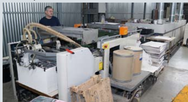
Трафаретная линия для нанесения лаковых покрытий на оттиск
