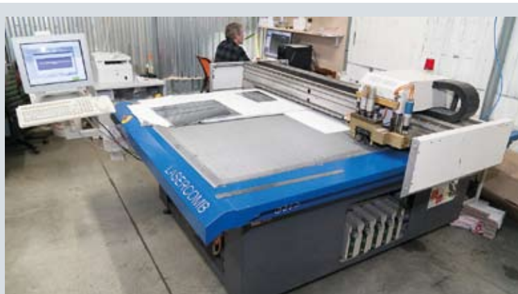
Для раскроя макета коробок используется режущий плоттер
