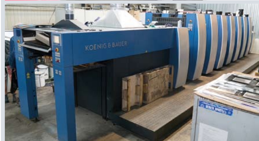
Парк печатного оборудования компании «Дельта Принт Т» — пятикрасочная машина Komori Lithrone S29+L и шестикрасочная Rapida 75 Pro с секцией УФ-лакирования
