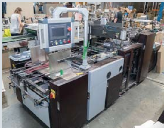
Косметическая упаковка зачастую требует наличия прозрачного пластикового окна. Вклейка окошек выполняется на данной производственной линии
