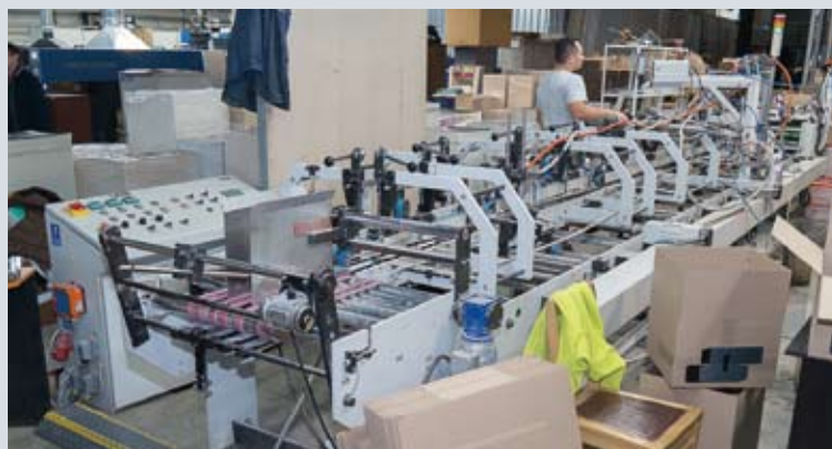
На предприятии работают две фальцевально-склеивающие линии
