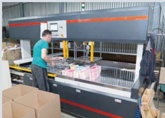
В начале этого года типография приобрела автоматическое устройство для удаления облоя и разделения заготовок, что повысило эффективность и качество технологической операции
