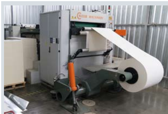
Размотка и резка рулонного картона на листы заданного формата позволяет сократить отходы материала
