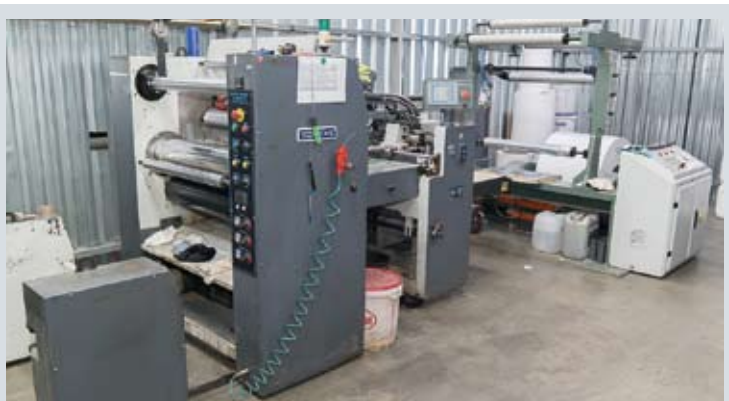
В типографии самостоятельно ламинируют картон металлизированной пленкой, что положительно сказывается на ценообразовании
