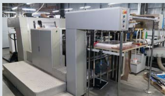
Оборудование для микроблинтования, с помощью которого можно придать оригинальный рельеф поверхности бумаги или картона или добиться уникальных оптических эффектов. Технология микротиснения часто используется в отделке премиальной упаковки
