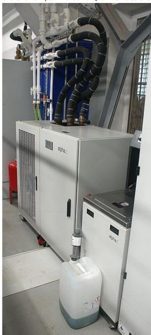
Система увлажнения Technotrans регулирует уровень изопропилового спирта в растворе с помощью опции Alcosmart: устройство работает без поплавка, что повышает точность измерения. Справа (за пластиковой канистрой с концентратом увлажнения) расположен фильтрующий модуль, который позволяет производить смену увлажняющего раствора гораздо реже
