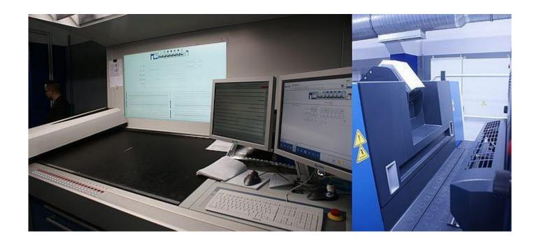
Система контроля печати обеспечивает неизменную плотность краски на оттиске в течение всего тиража. Слева — пульт управления со сканирующим спектрофотометром, справа — камера, которая контролирует изображение на каждом оттиске
