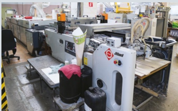
На фото трафаретная машина и лакировальная линия для выборочного и сплошного нанесения УФ и ВД-лаков
